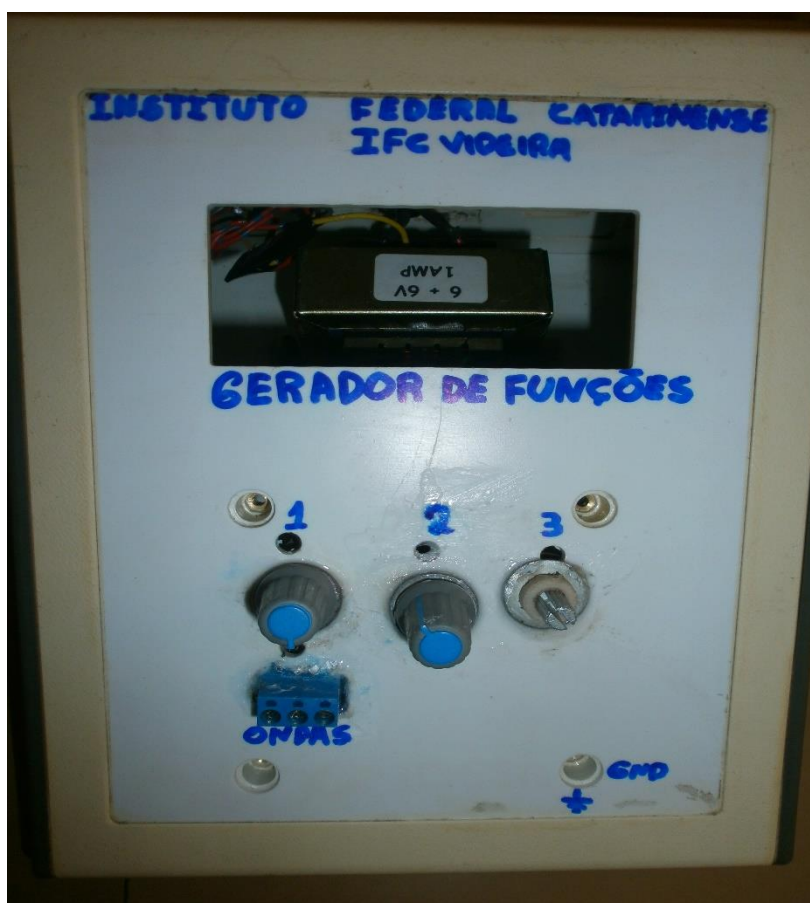
Figura 6– Produto Final, gerador de funções de baixo custo Fonte: (ARQUIVO PESSOAL, 2013)
