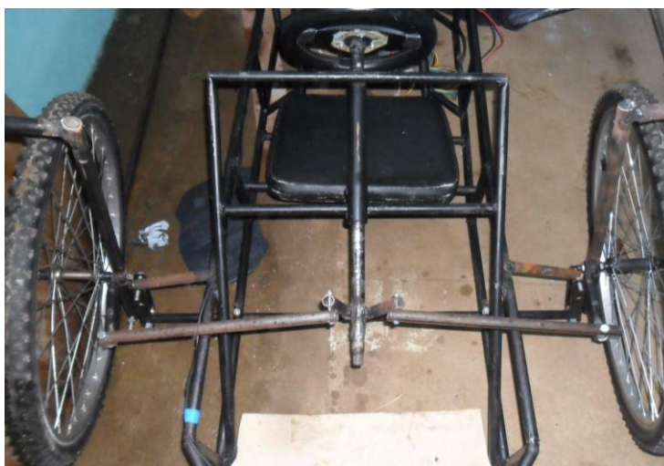
Figura 3: Sistema de direção com estrutura tubular.
