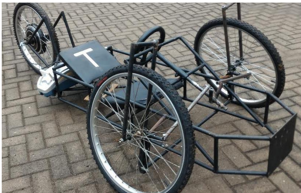
Figura 2: Veículo elétrico montado sob o chassi.
