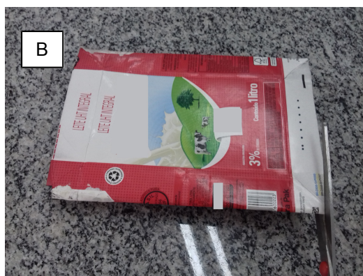
Figura 02 – Cortes realizados nas partes superior e inferior (A) e lateral (B) para abertura das embalagens Tetra Pak.
