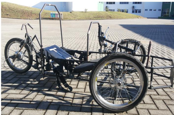
Figura 1- Carroceria do veículo elétrico desenvolvido no IFC Videira.
