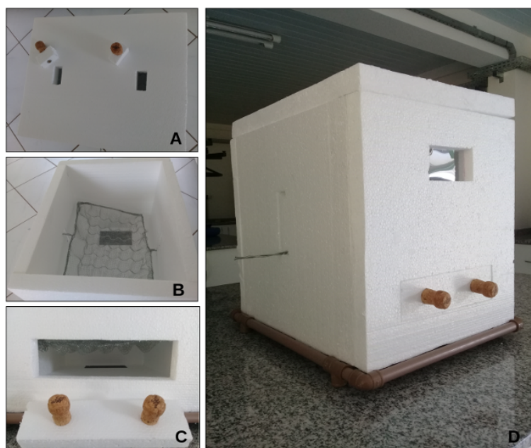
Figura 1 – Detalhes e chocadeira desenvolvida. A: Parte superior com respiros; B: Suporte de ovos inclinado; C: Abertura para colocação de prato com água; D: Chocadeira com visor e suporte de PVC.
