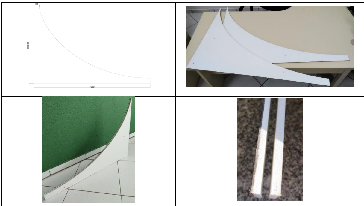
Figura 2: Imagens do processo de obtenção do perfil de cicloide estudado.
