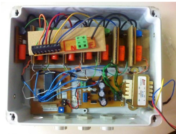
Figura 5 - Caixa de comando. Dentro dela estão a fonte de alimentação canto inferior à esquerda, a central de controle canto inferior à direita, e os atuadores responsáveis por apagar e acender as lâmpadas.
