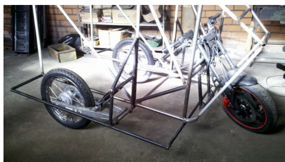
f) Montagem das balanças traseiras na estrutura
