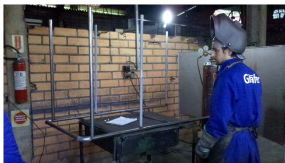
b) Primeiras montagens da estrutura no esquadro
