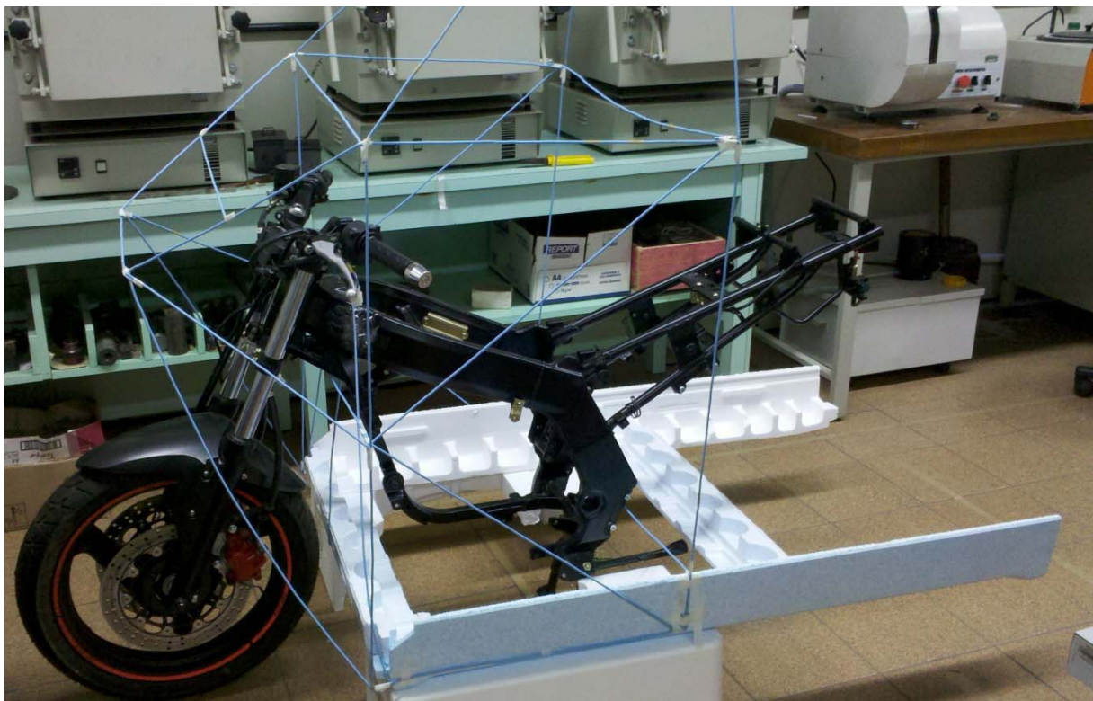
Figura 2. Chassi da motocicleta integrado ao modelo da estrutura do triciclo, em arame.
