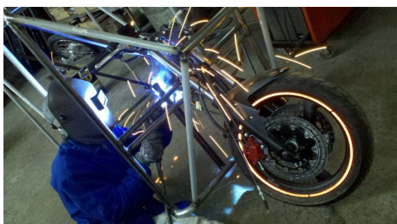
e) Soldagem do chassi da motocicleta na estrutura
