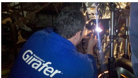
a) Corte do chassi da motocicleta no plasma
