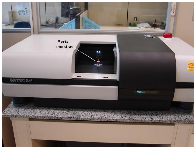
Figura 2 – Microtomógrafo Skyscan 1171, fonte de raios X de 20 – 100 kV, potência máxima de 10 W.
